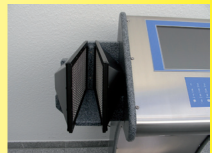
Bild 4: Ausführung mit 2 Detektoren pro Hand, senkrechte Anordnung
