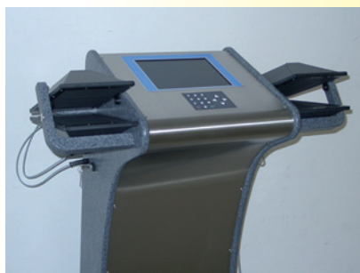
Bild 3: Ausführung mit 2 Detektoren pro Hand, waagerechte Anordnung
